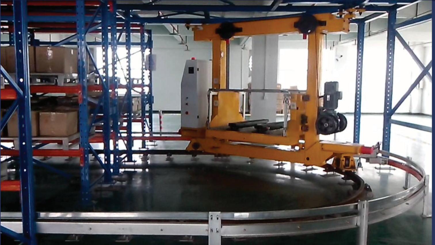
TRANSELEVADOR DE DOBLE COLUMNA CON CAMBIO DE VÍAS, ALMACÉN AUTOMATIZADO.
