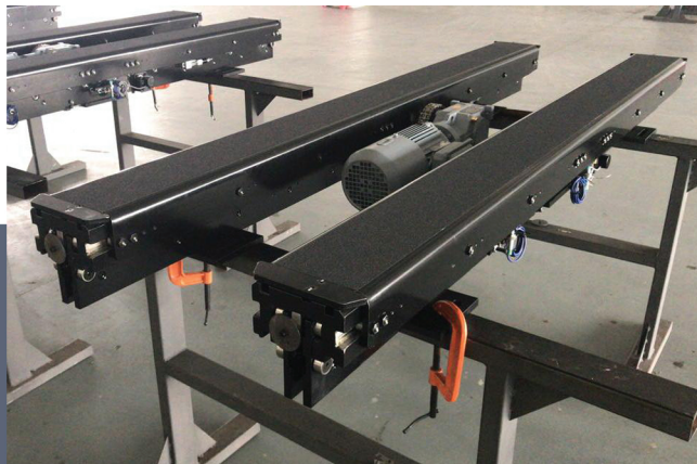
HORQUILLAS DE EXTENSIÓN SENCILLA: PARA SISTEMAS DE FONDO SENCILLO
