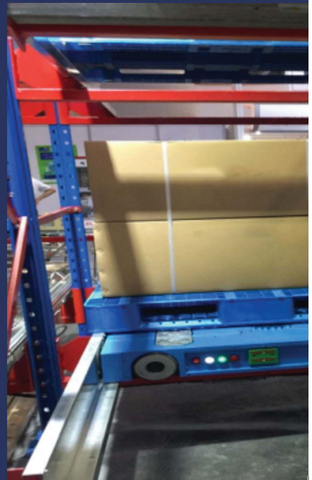
TRANSELEVADOR DE DOBLE COLUMNA CON CAMBIO DE VÍAS, ALMACÉN AUTOMATIZADO.
