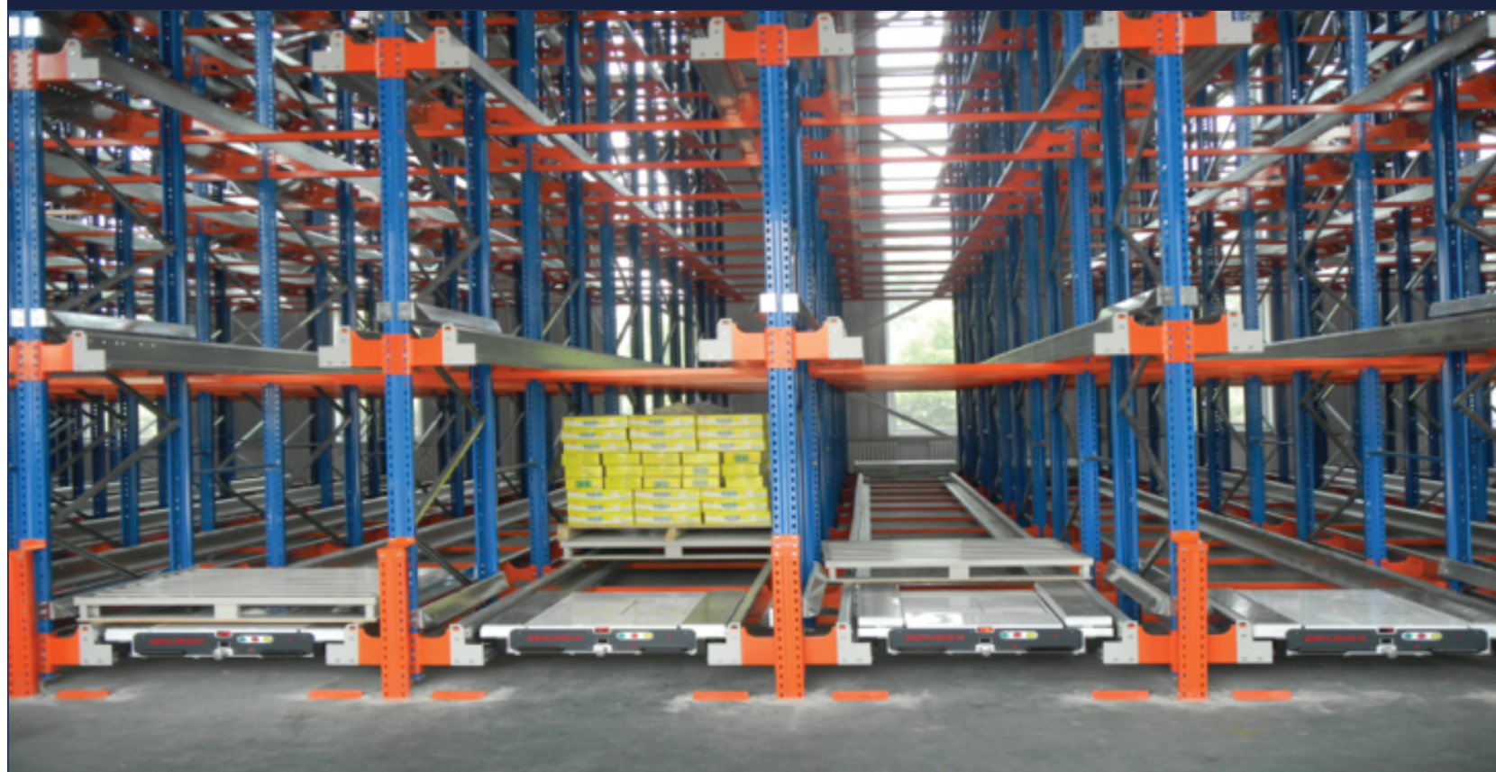
SOLUCIÓN TRADICIONAL: SHUTTLE + MONTACARGAS, ALMACÉN SEMIAUTOMÁTICO
